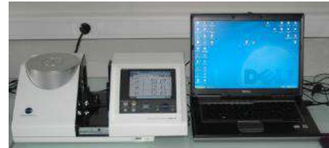
Spectrophotomètre IR (Identification des matériaux)
